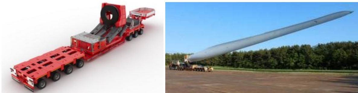
Figura 4: Blade-lifter utilizzato per ridurre gli spazi liberi e di manovra necessari per il trasporto dei componenti dell'aerogeneratore
