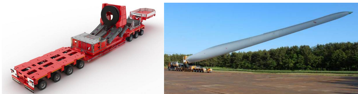
Figura 3.3/A - Blade-lifter utilizzato per ridurre gli spazi liberi e di manovra necessari per il trasporto dei componenti dell'aerogeneratore
