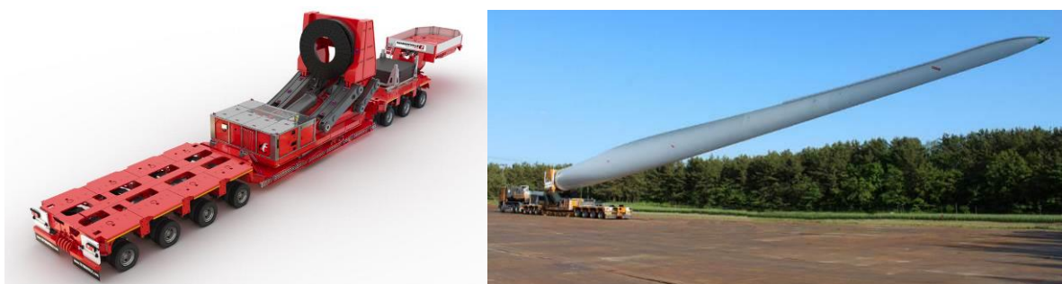
Figura 3.3/A - Blade-lifter utilizzato per ridurre gli spazi liberi e di manovra necessari per il trasporto dei componenti dell'aerogeneratore
