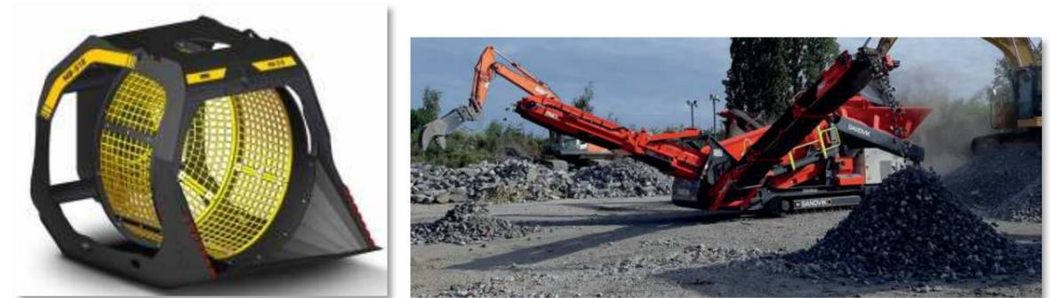
Figura 14 Escavatore dotato di Vaglio Rotante
