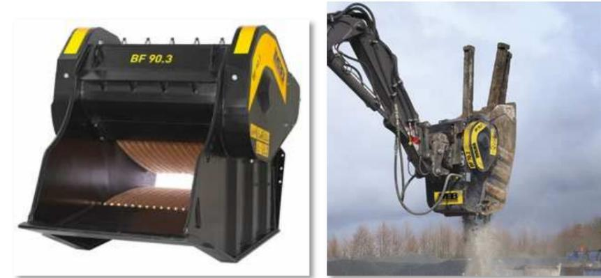
Figura 13 Escavatore dotato di Mulino a mascelle
