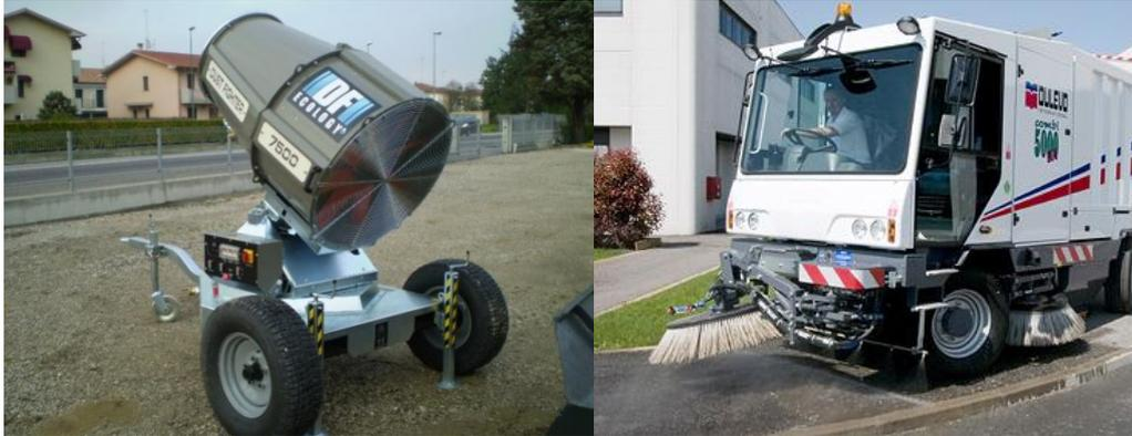
**Figura 38** Esempio di mezzi per l'abbattimento di polveri
