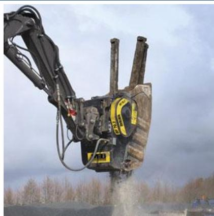
**Figura 17** Escavatore dotato di Mulino a mascelle
