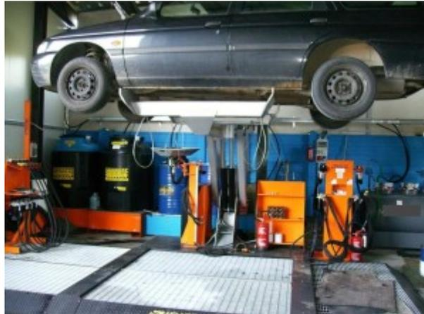
Figura 25 – Isola di bonifica in autodemolizione (Immagine Illustrativa)
