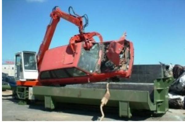
Figura 29 – Pressa-cesoia per autodemolizione (Immagine Illustrativa)
