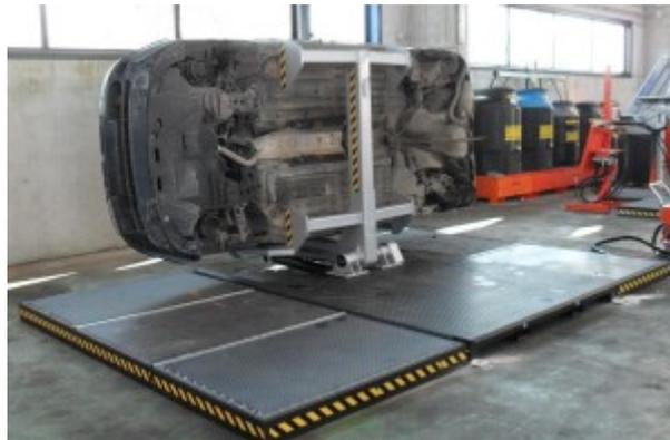
Figura 27 – Applicazione in autodemolizione di un ribaltatore (Immagine Illustrativa)
