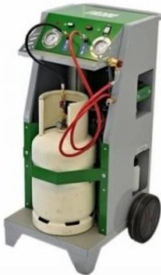
Figura 45 – Estrattore di gas di condizionamento a singola bombola, con sistema di auto-evacuazione per la sostituzione della bombola quando cambia il tipo di gas da aspirare (Immagine Illustrativa)
