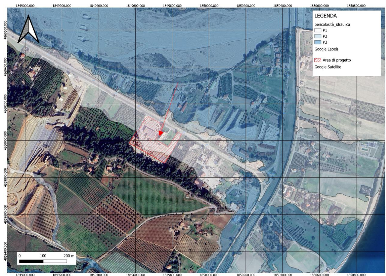
Figura 10_Inquadramento area su mappa Pericolosità idraulica
