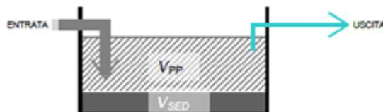
Volume di separazione:  $V_{SEP} = Q \times t_s$
