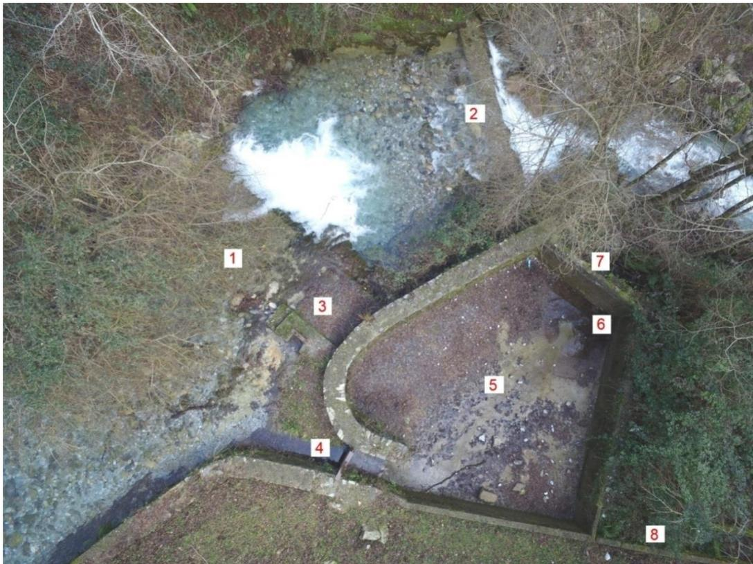
Figura 5 – Vista da Drone dello stato di sussistenza dell’opera e delle sue parti costituenti: traversa in alveo (1), contro-briglia (2), setto di spurgo (3), setto di captazione (4), vasca di sedimentazione (5), scarico di fondo della vasca (6), sfioratore di superficie della vasca (7), canale di derivazione (8)
