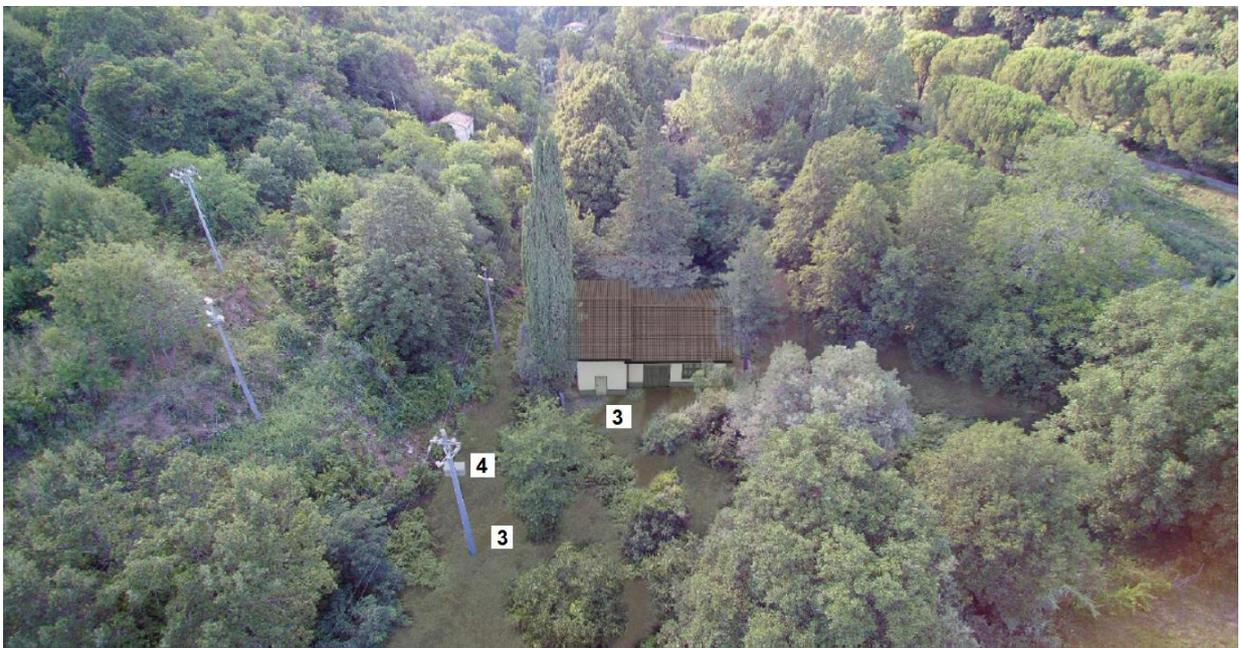
Figura 23 – Vista delle opere della linea elettrica: con le indicazioni n. 3 il tracciato del cavidotto interrato; l'indicazione n. 4 mostra il dispositivo da installare sul sostegno a palo in servizio
