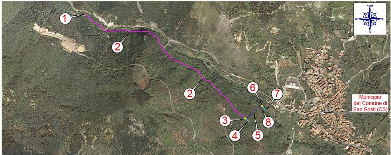
Figura 2 – Planimetria di ubicazione delle opere dell'impianto idroelettrico esistenti nel Comune di San Sosti (CS).
