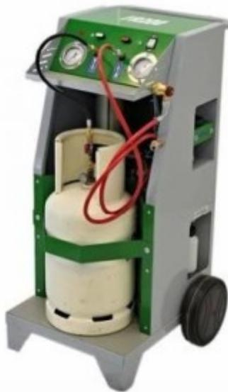
Figura 45 – Estrattore di gas di condizionamento a singola bombola, con sistema di auto-evacuazione per la sostituzione della bombola quando cambia il tipo di gas da aspirare
