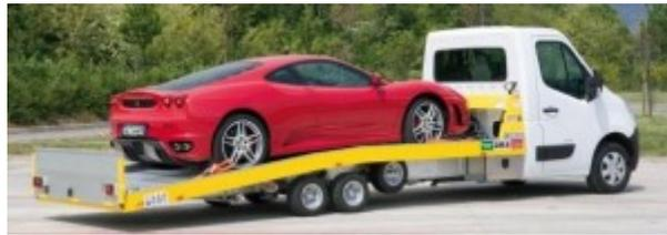
Figura 21 – Carroattrezzi per il trasporto di singole autovetture.
