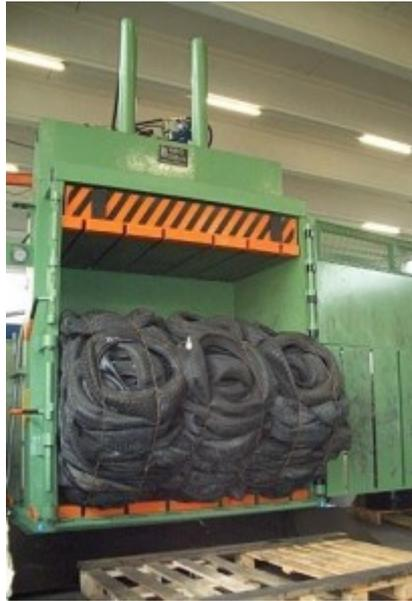
Figura 34 – Applicazione di pressa legatrice per pneumatici
