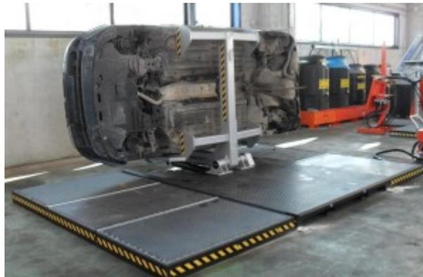
Figura 27 – Applicazione in autodemolizione di un ribaltatore.
