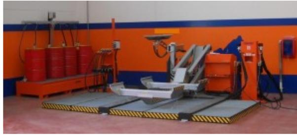
Figura 24 – Isola di bonifica con aspirazione liquidi (4 linee) e carburanti (2 linee) e stoccaggio integrato interno dei liquidi.
