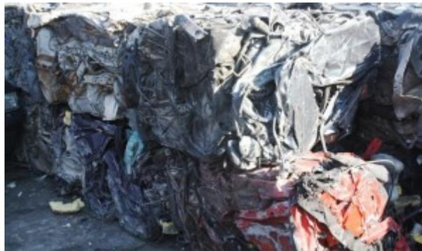
Figura 30 – Pacchi derivanti dalla pressatura dei veicoli
