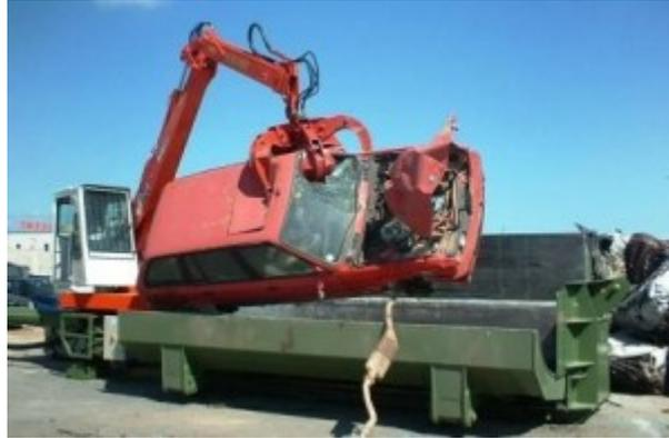
Figura 29 – Pressa-cesoia per autodemolizione
