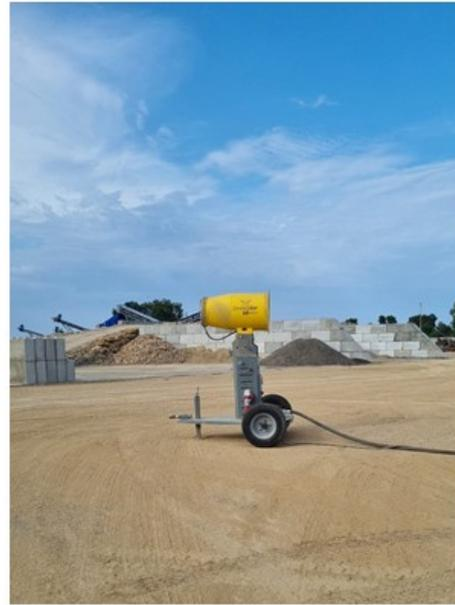
La bagnatura delle superfici di transito dei mezzi o la bagnatura delle aree sulle quali vengono effettuate le lavorazioni con conseguente movimentazione dei cumuli di materiale è necessaria sia a limitare la generazione di polvere, sia a far precipitare a terra le polveri aeree disperse che inevitabilmente si generano seppur in misura ridotta.
