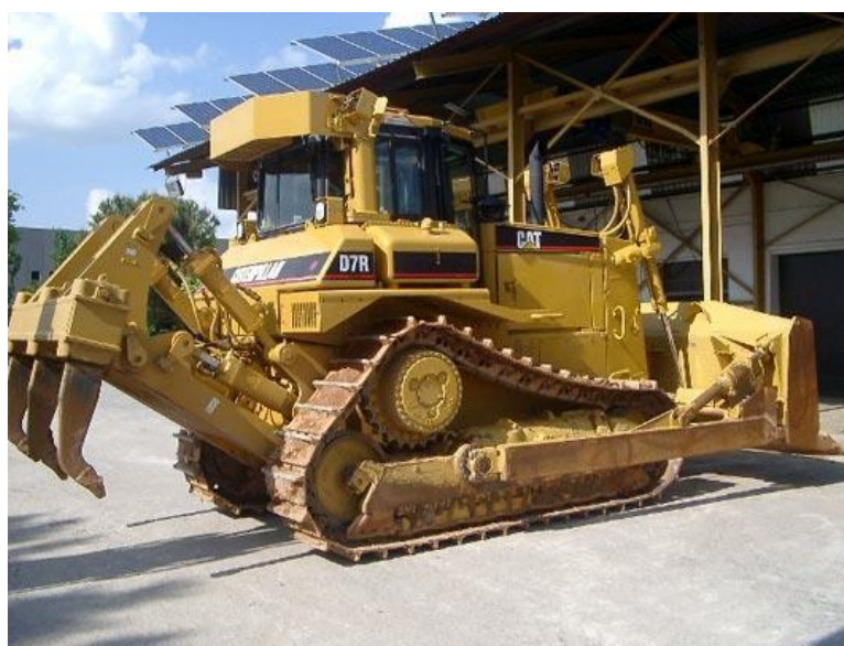
Fig. 23: Dozer equipaggiato con ripper
