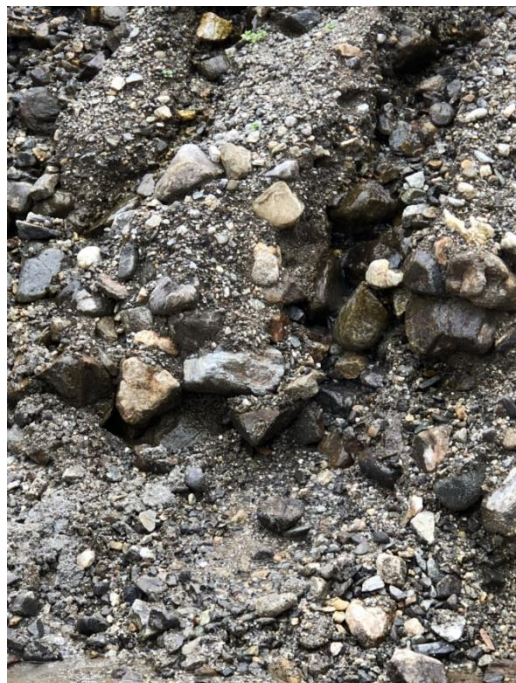
Figura 4.14 - A sinistra: depositi alluvionali mobili presenti lungo il tracciato. A destra dettaglio dei depositi alluvionali ciottolosi.
