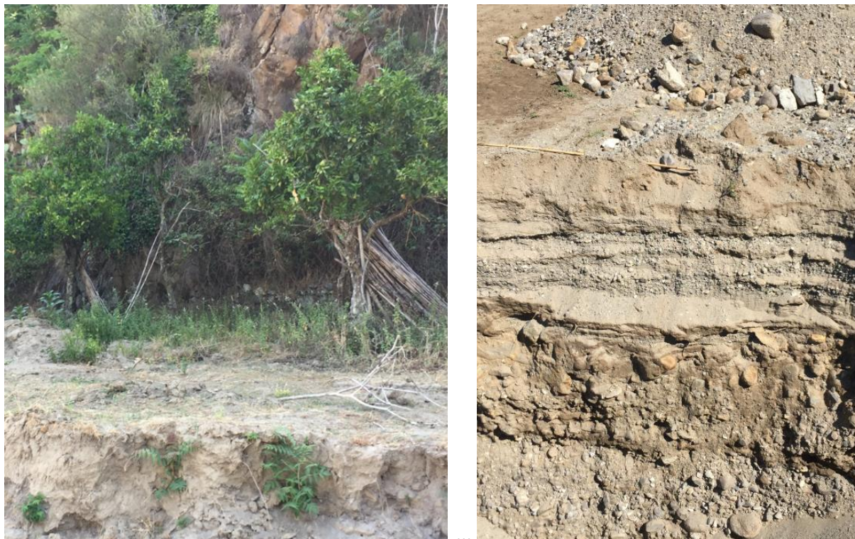
Figura 4.15 - A sinistra: depositi alluvionali stabilizzati. A destra: aree extra-arginali. Dettaglio di una scavo eseguito nei depositi stabilizzati.
