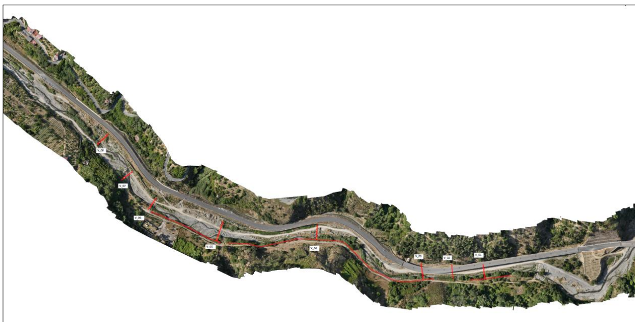
Figura 3.4 – Planimetria degli interventi. Tratto di valle. Briglie e muro di contenimento.
