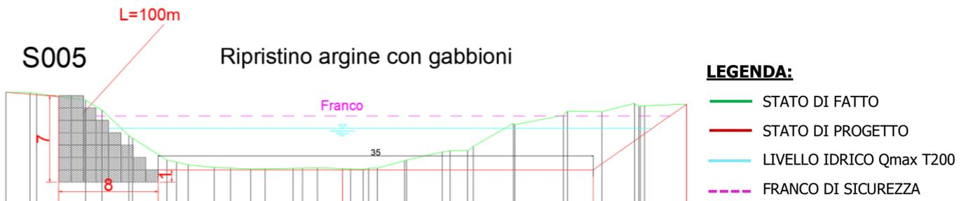
**Fig. 35:** Fiume Lipuda – Sezione con indicazione delle gabbionate di progetto
