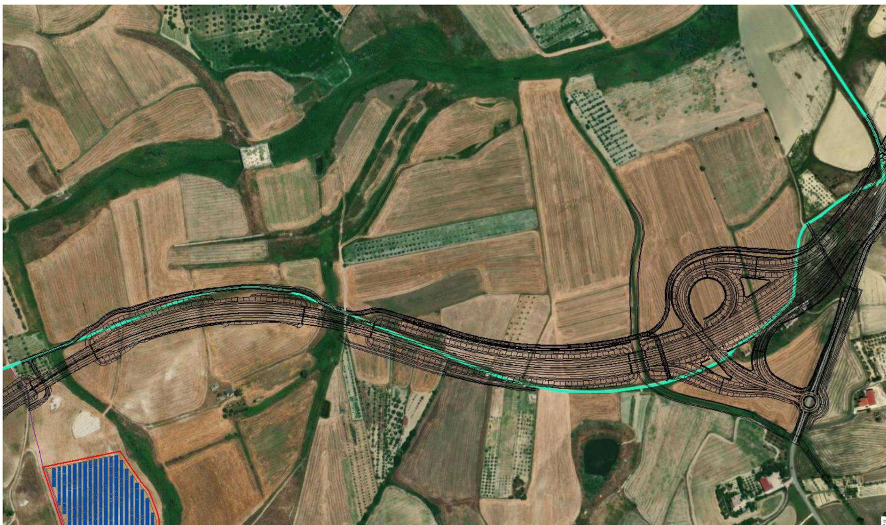
Fig.6 Cavidotto Esterno MT dell'Impianto Fotovoltaico Autorizzato (tratti in verde) e interferenze con progetto ANAS (tratti in nero)
