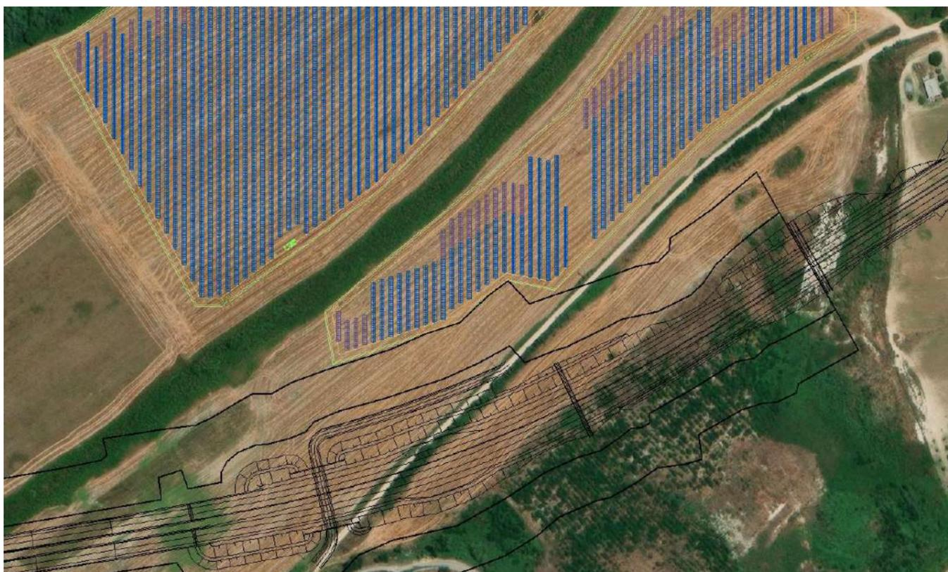
Fig.9 Modifica progettuale dell'Impianto Fotovoltaico Autorizzato per risoluzione interferenza part. 69 foglio 29 (progetto ANAS in nero)
