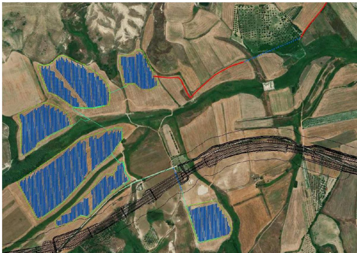
Fig.10 Modifica progettuale del cavidotto di collegamento fra il campo a sud-est e la cabina di raccolta per risoluzione interferenza SS106 (progetto ANAS in nero)
