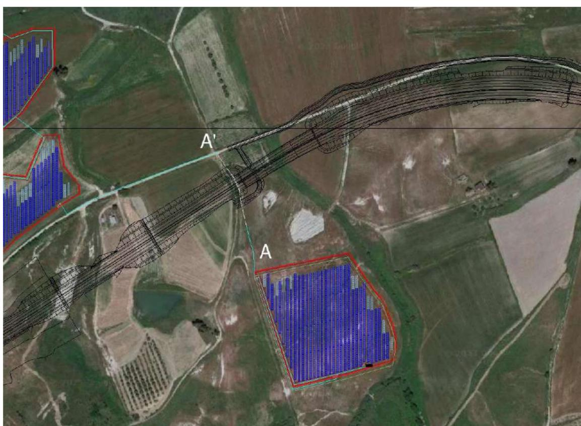
Fig.11 Dettaglio Modifica progettuale del cavidotto di collegamento fra il campo a sud-est e la cabina di raccolta per risoluzione interferenza SS106 (progetto ANAS in nero)
