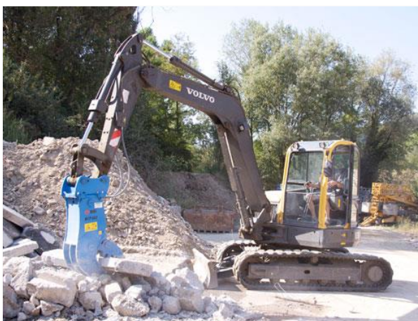
Figura 5 Escavatore dotato di pinza frantumatrice
