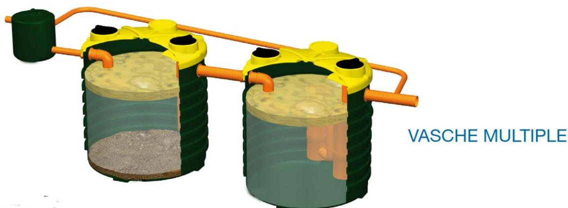
**Figura 10** Schema Impianto di trattamento acque di dilavamento
