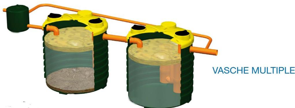
**Figura 17** Schema Impianto di trattamento acque di dilavamento
