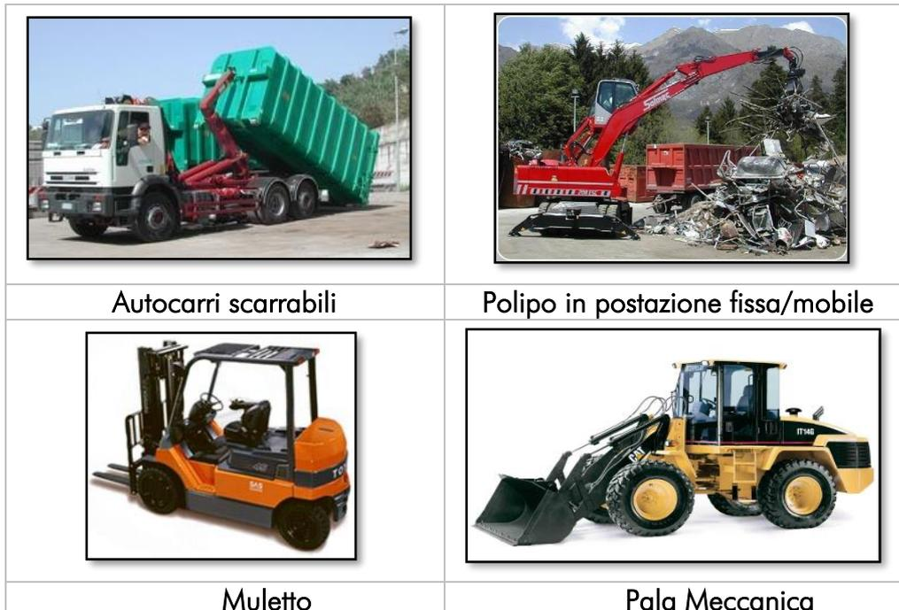
**Figura 15** Attrezzature per la movimentazione dei rifiuti
