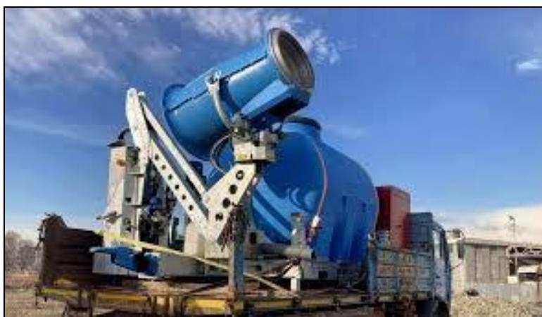
**Figura 27** Esempio di cannone nebulizzatore per l'abbattimento di polveri
