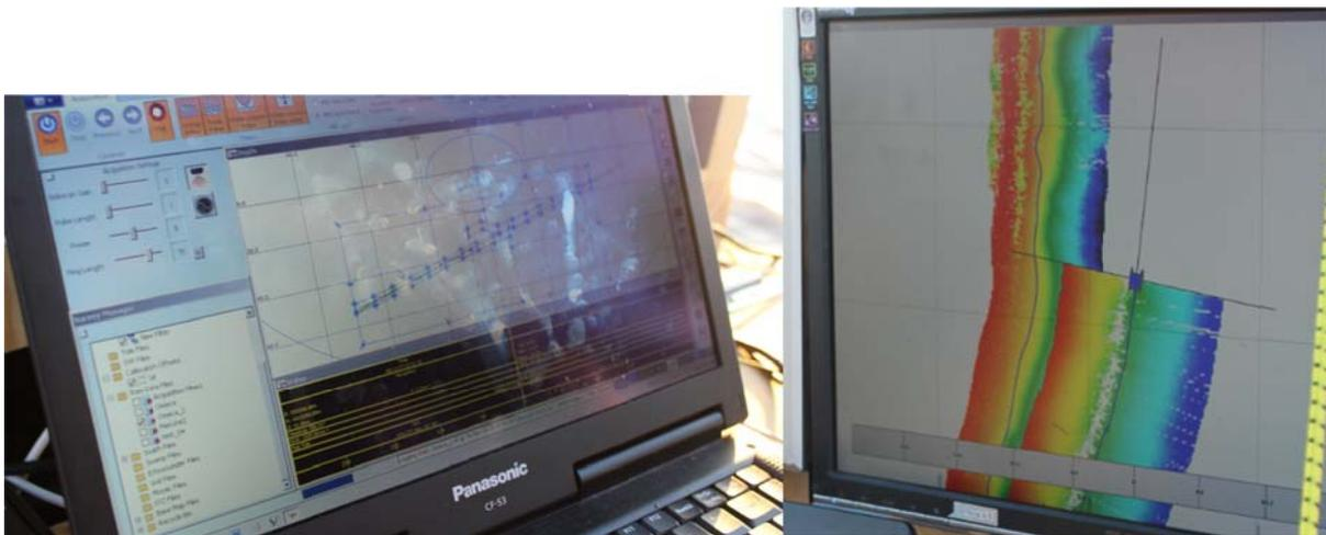
Figura 8. Software di acquisizione dati Kongsberg GS4. A sinistra, l'applicazione dei filtri per l'individuazione del fondale. A destra la larghezza del fascio emesso dai due trasduttori con relativa scala della colorimetria della profondità rilevata.
