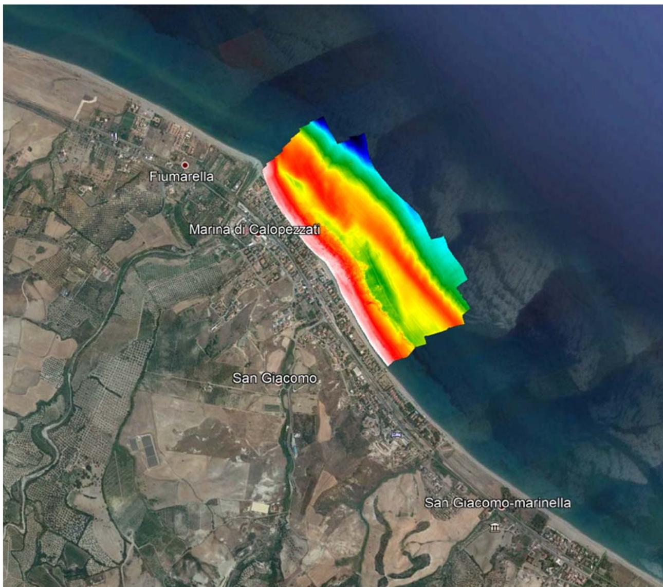
*Figura 21. Mappa batimetrica in scala di colori e sovrapposizione del rilievo all'area di indagine.*
