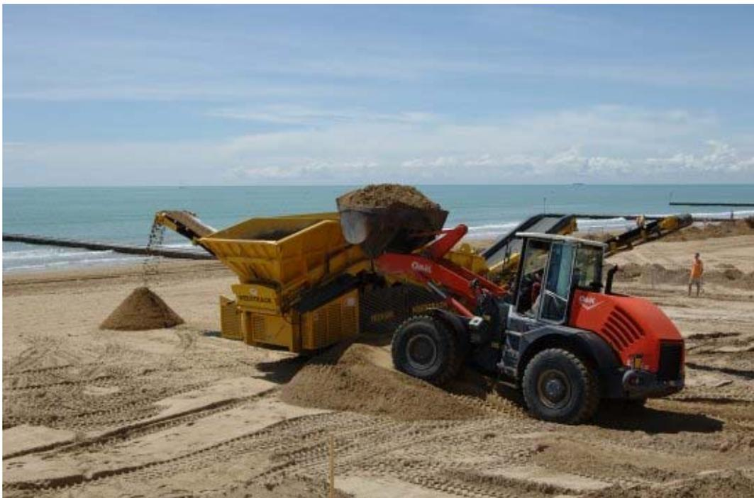
*Figura 38 – Lavorazione di vagliatura della sabbia*
