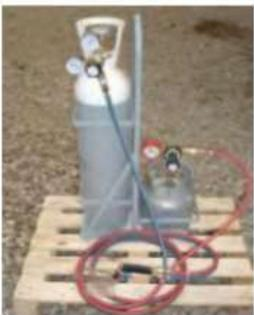
Premesso che nel sito si prediligeranno le operazioni di riduzione volumetriche di tipo meccaniche mediante mezzi dotati di cesoie idrauliche, trituratore e mulino solo alcuni tagli, in casi eccezionali, verranno eseguiti a caldo mediante l'uso di cannello ossi-propanico.
