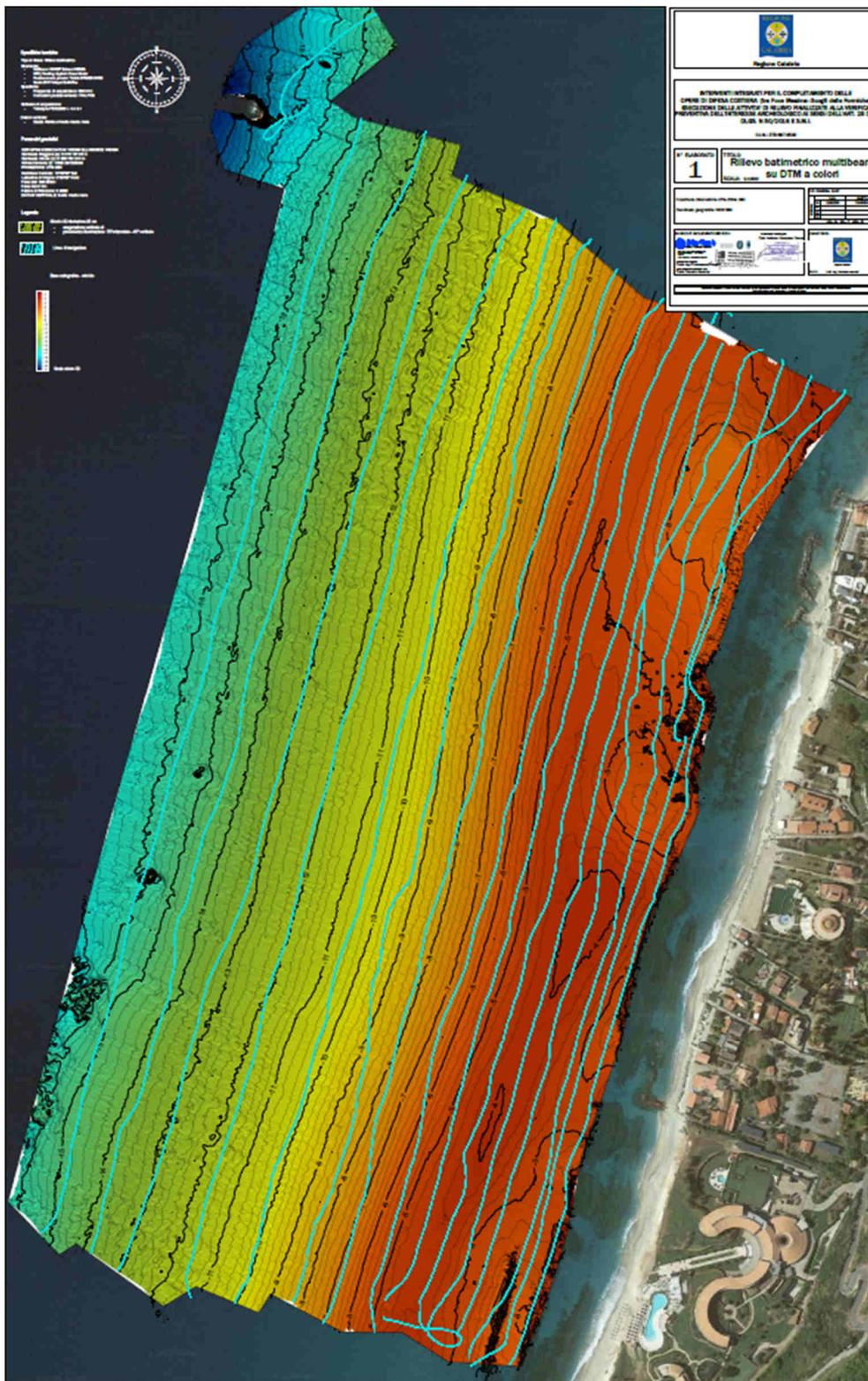
**FIGURA 37- DTM CON IL DETTAGLIO DELLE ISOBATE RESTITUITO A SEGUITO DEL RILIEVO BATIMETRICO MULTIBEAM.**
