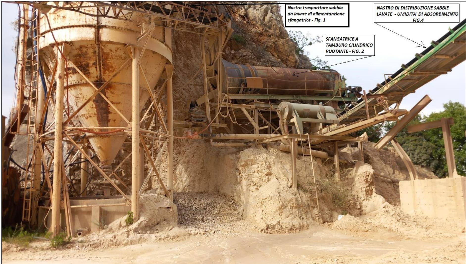
I limi provenienti dal ciclo di lavaggio delle sabbie, presenti nella torbida, vengono decantati attraverso il silos verticale cilindrico che agisce come decantatore statico (per gravità), *senza alcuna aggiunta di flocculanti o additivi chimici*.
