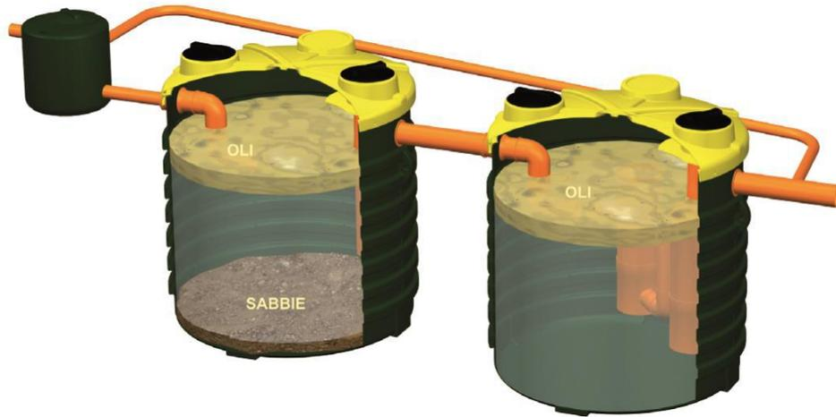
Figura 1: Sistema per il trattamento in continuo delle acque di pioggia (IPC1000).
