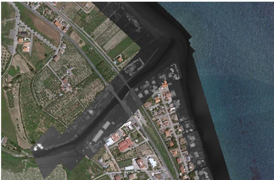
Figura 9 DEM utilizzato per la modellazione idraulica del T. Fiumarella
