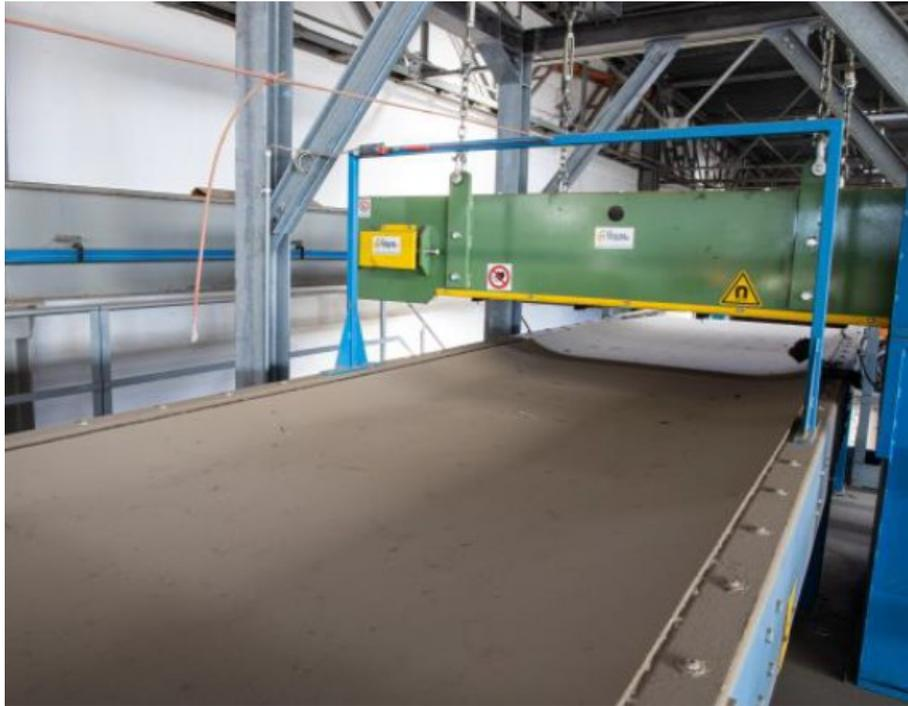
*Figura 11: Separatore elettromagnetico "OVERBAND"*
