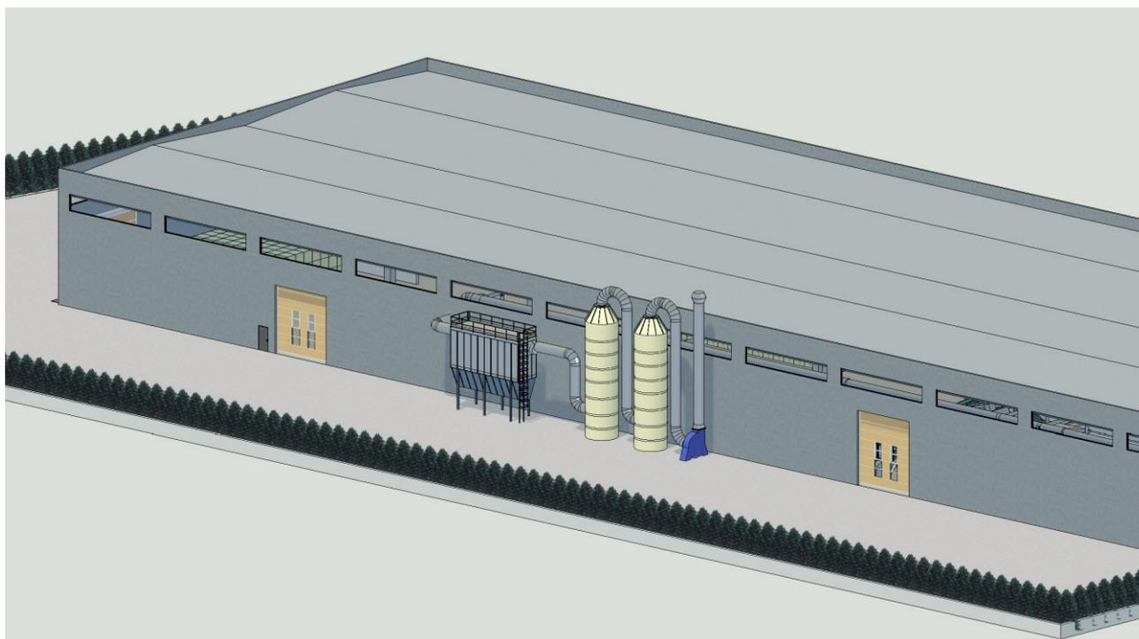
Figura 6: Vista prospettica sistema di abbattimento emissioni in atmosfera
