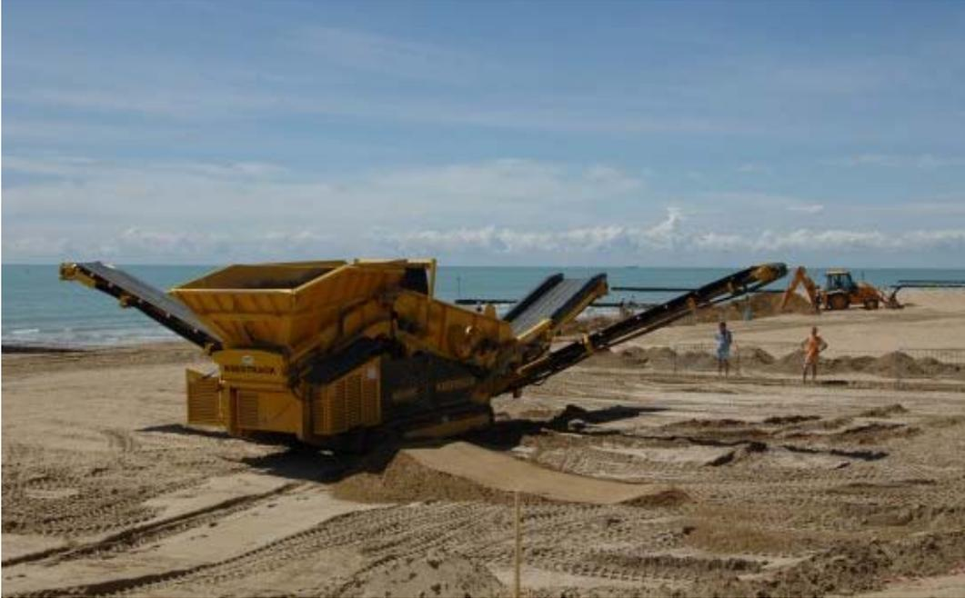
*Figura 53 – Lavorazione di vagliatura della sabbia*
