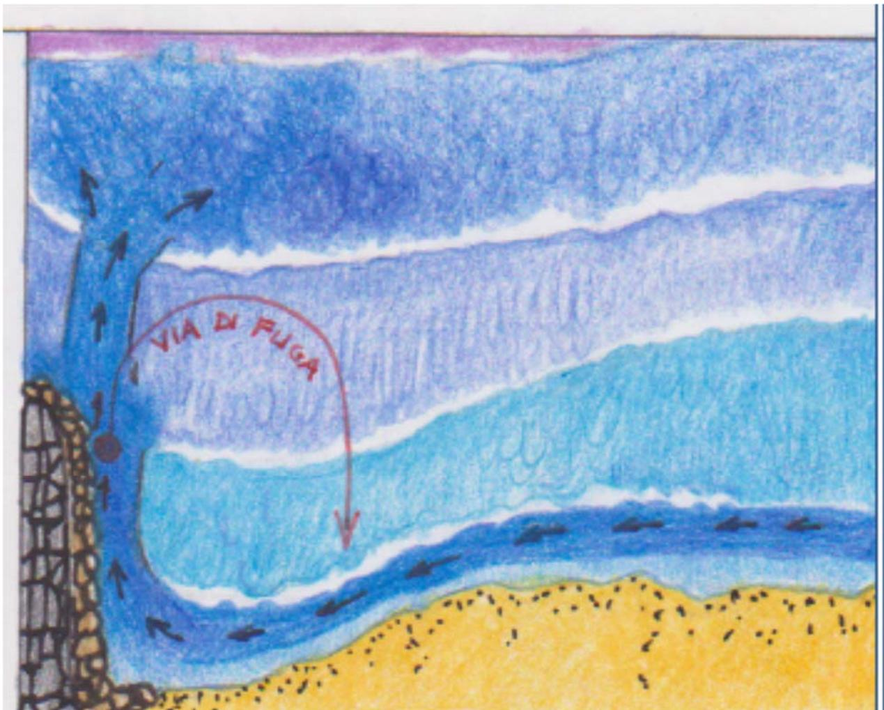
Figura 46 – Schematizzazione del flusso dei sedimenti sottoflutto
