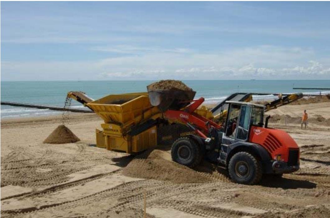
*Figura 54 – Lavorazione di vagliatura della sabbia*
