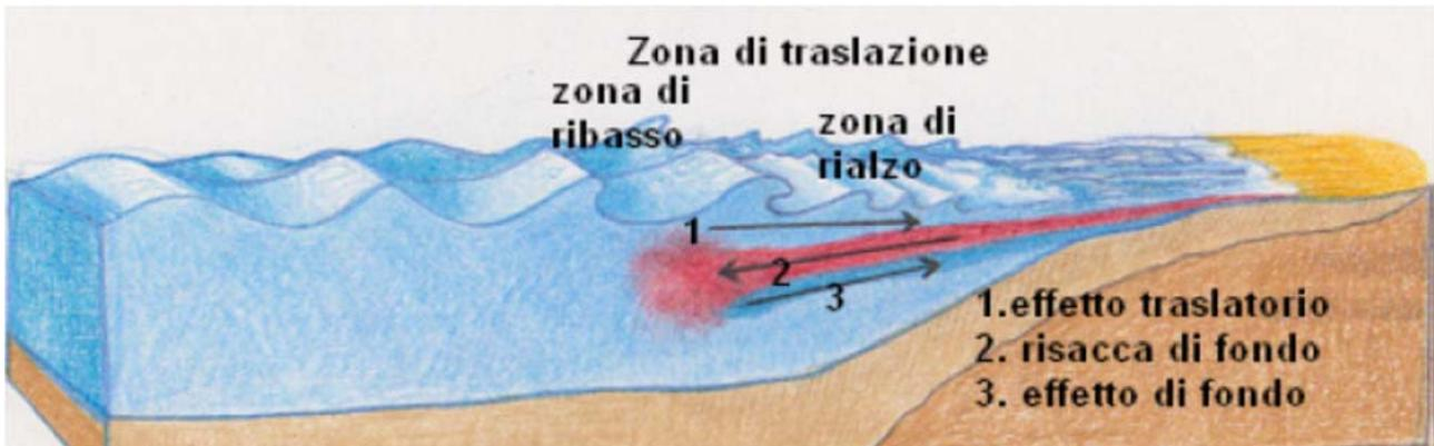
Figura 24 – Schema di propagazione delle onde
