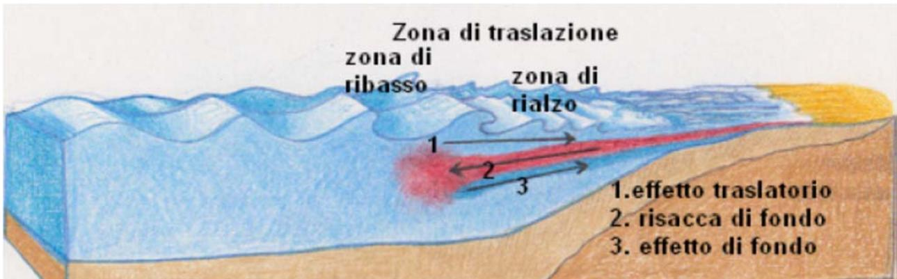
Figura 38 – Schema di propagazione delle onde
