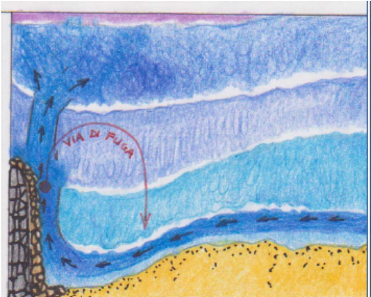
Figura 39 – Schematizzazione del flusso dei sedimenti sottoflutto
