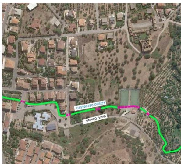
Figura 3-2 Inquadramento planimetrico Via Canova, a monte dell'abitato di Mirto. In verde la rappresentazione del canale a cielo aperto, in fucsia i tratti tombinati
