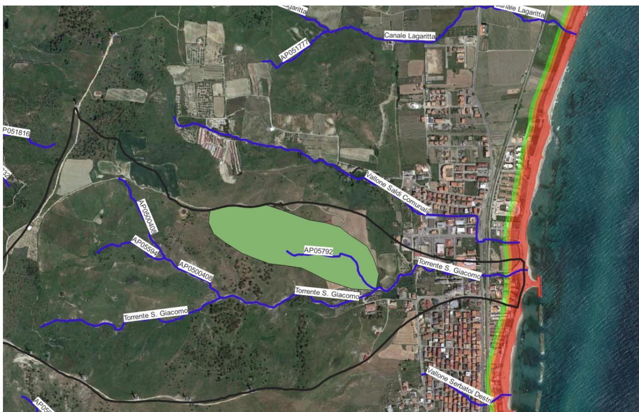
Figura 15: Planimetria del corso d'acqua con indicazione del sottobacino per il tributario di sinistra
