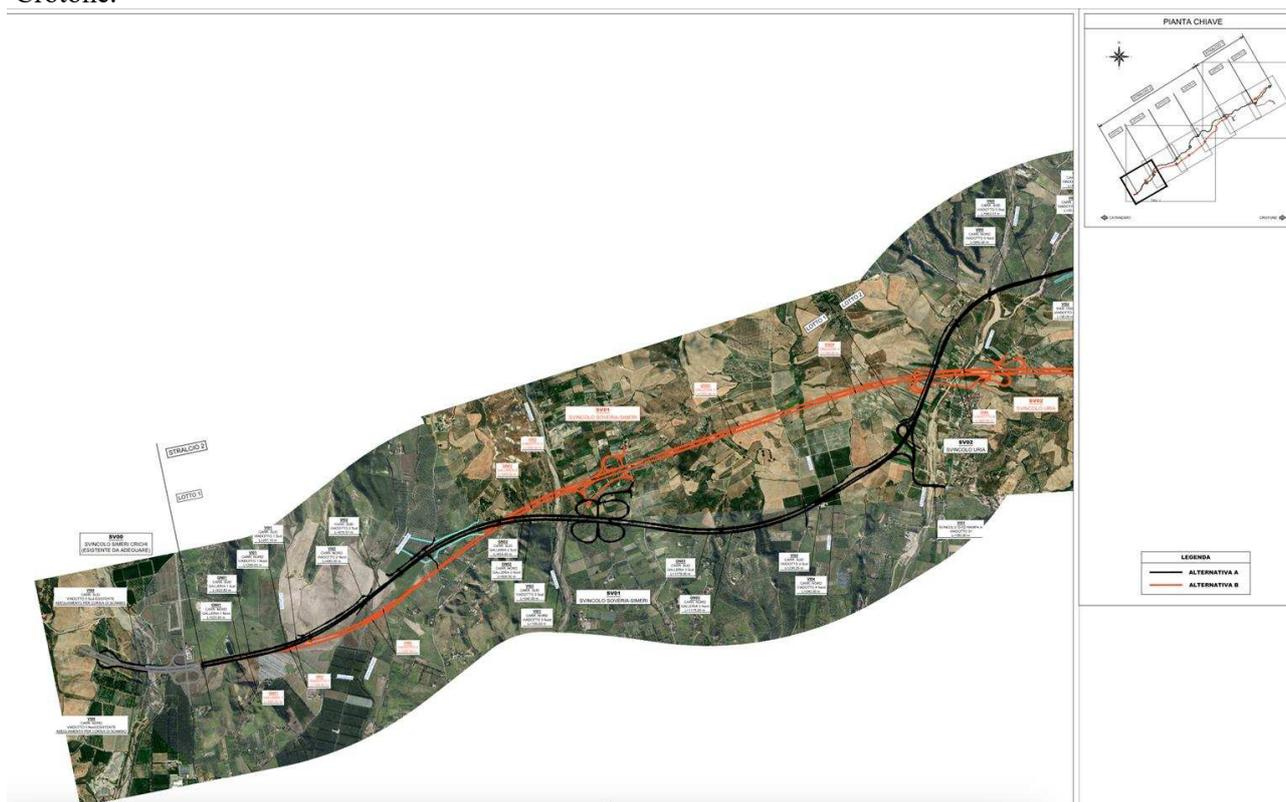
Nella progettazione del completamento dello svincolo di Simeri Crichi sono stati previsti due tronchi di scambio che permettono di eliminare completamente le due rampe di ingresso/uscita parzialmente realizzate in direzione Crotona, garantendo un ripristino ambientale delle superfici pavimentate, che risultano troppo vicine agli imbocchi della galleria GN01 di nuova realizzazione.
