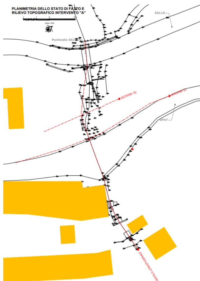
Figura 5.1 - Planimetria di rilievo topografico lungo l'asta fluviale T. Fallà
