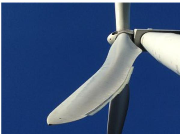
**Figura 1 LNTE sulla pala del rotore della turbina eolica**
