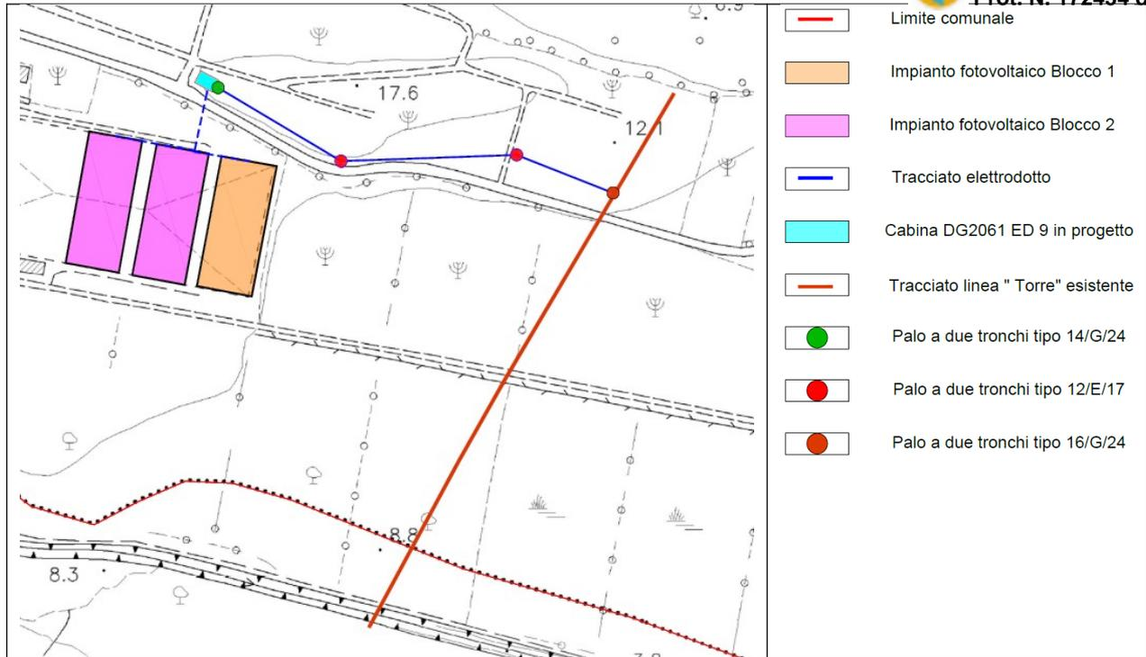
L'installazione dell'impianto fotovoltaico avverrà attraverso una disposizione delle strutture su file parallele orientate in modo da seguire l'attuale configurazione delle serre.
