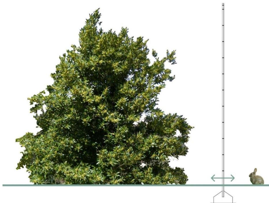
Figura 8 - Esempio di recinzione separata dal suolo di circa 20 cm per permettere il passaggio della fauna
