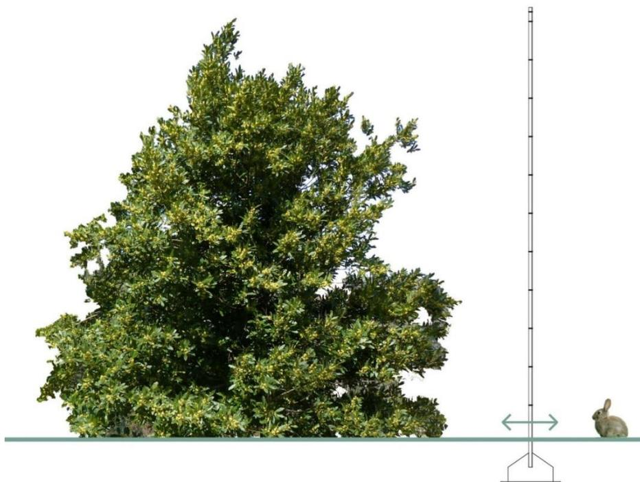
Figura 45 - Esempio di recinzione separata dal suolo di circa 20 cm per permettere il passaggio della fauna
