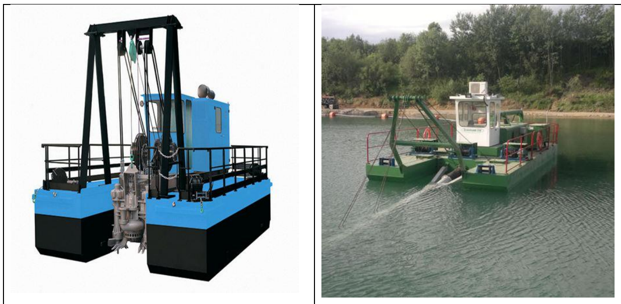
Figura 21: Pompa aspirante-refluente per dragaggio montata su galleggiante
