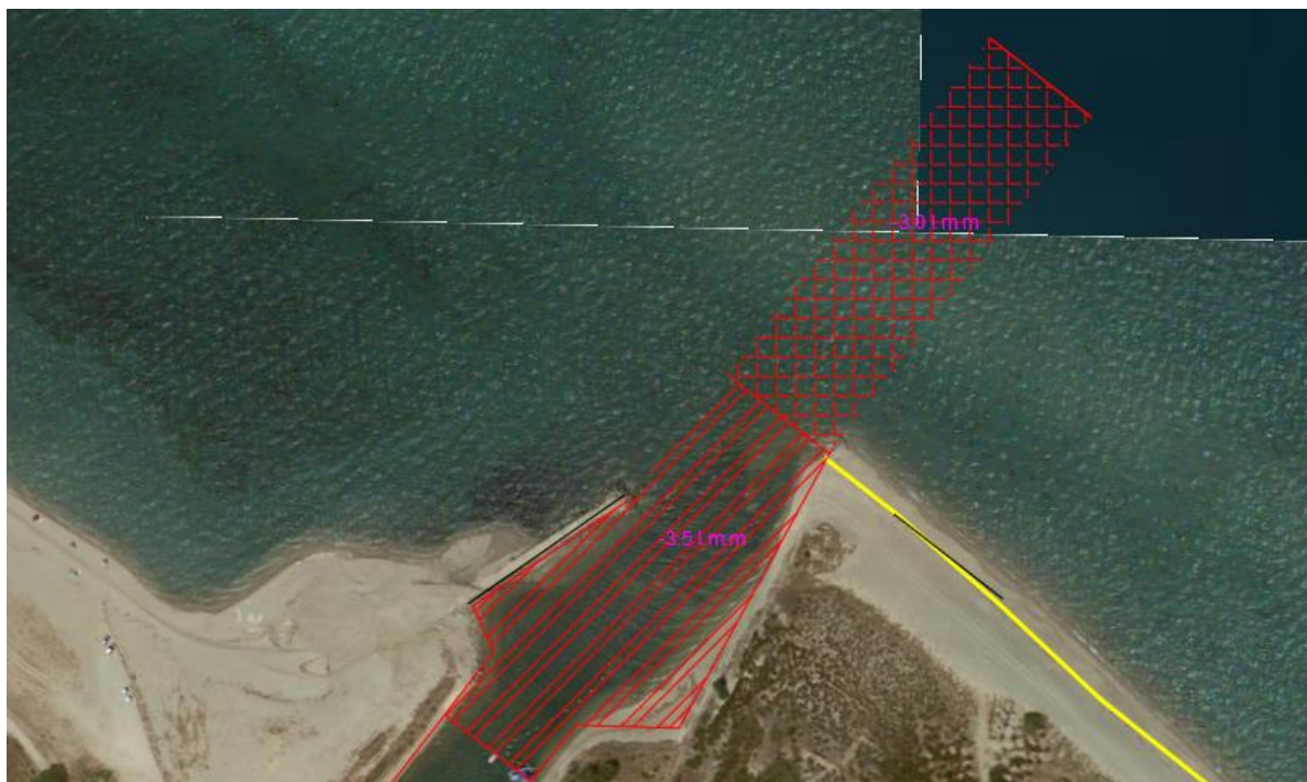
Figura 30: FASE3: Planimetria di dragaggio area foce Stombi
