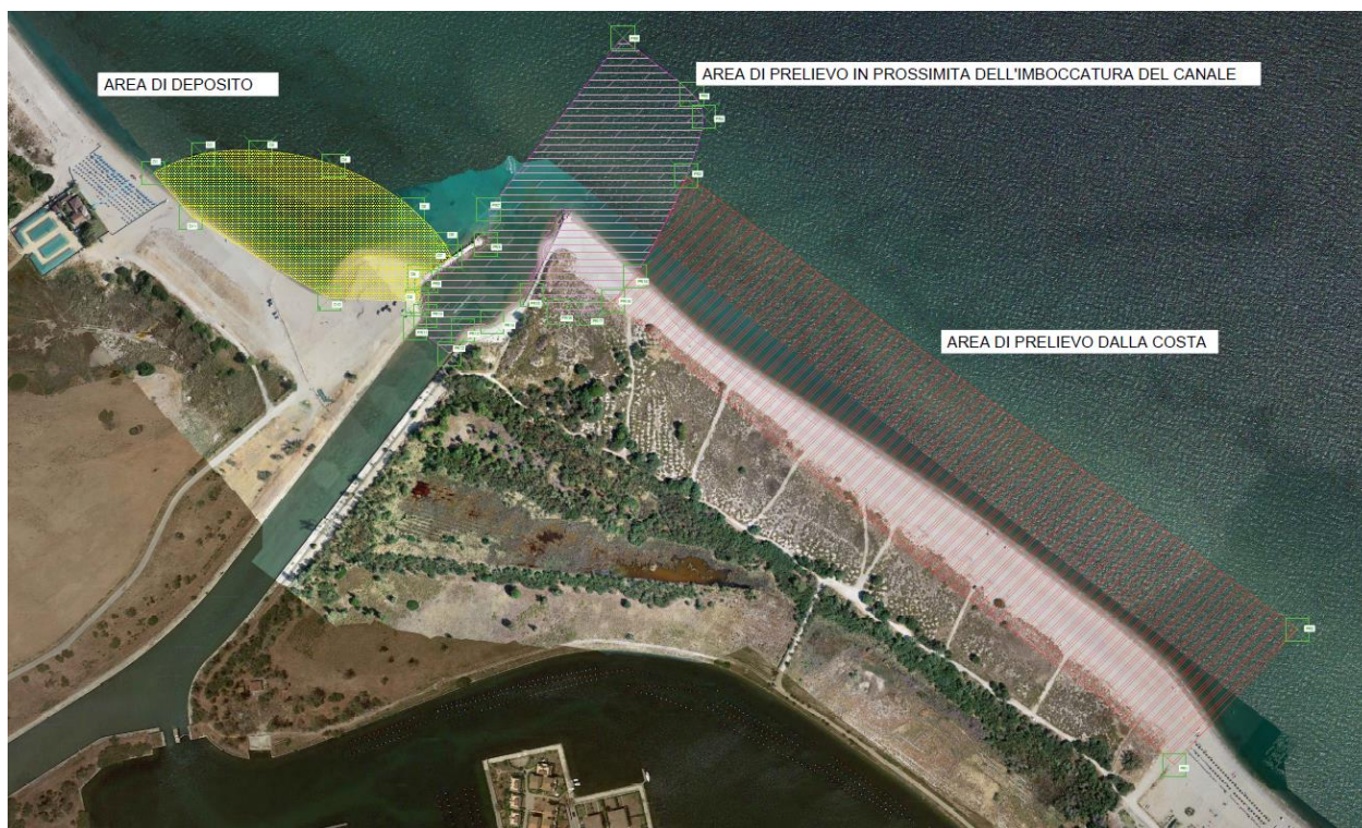
Figura 19: Rappresentazione dell'area di movimentazione dei sedimenti
