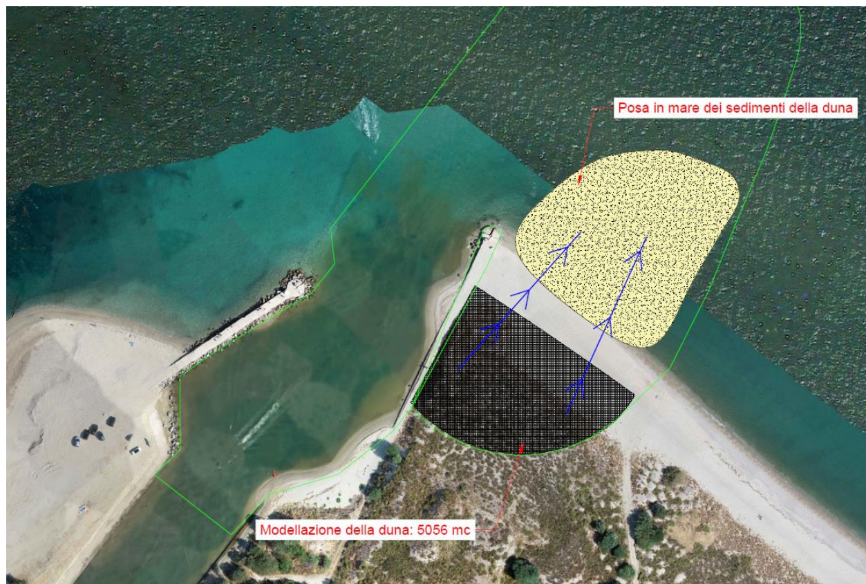
Figura 32: FASE 1: mobilitazione dei sedimenti della duna e convogliamento a mare
