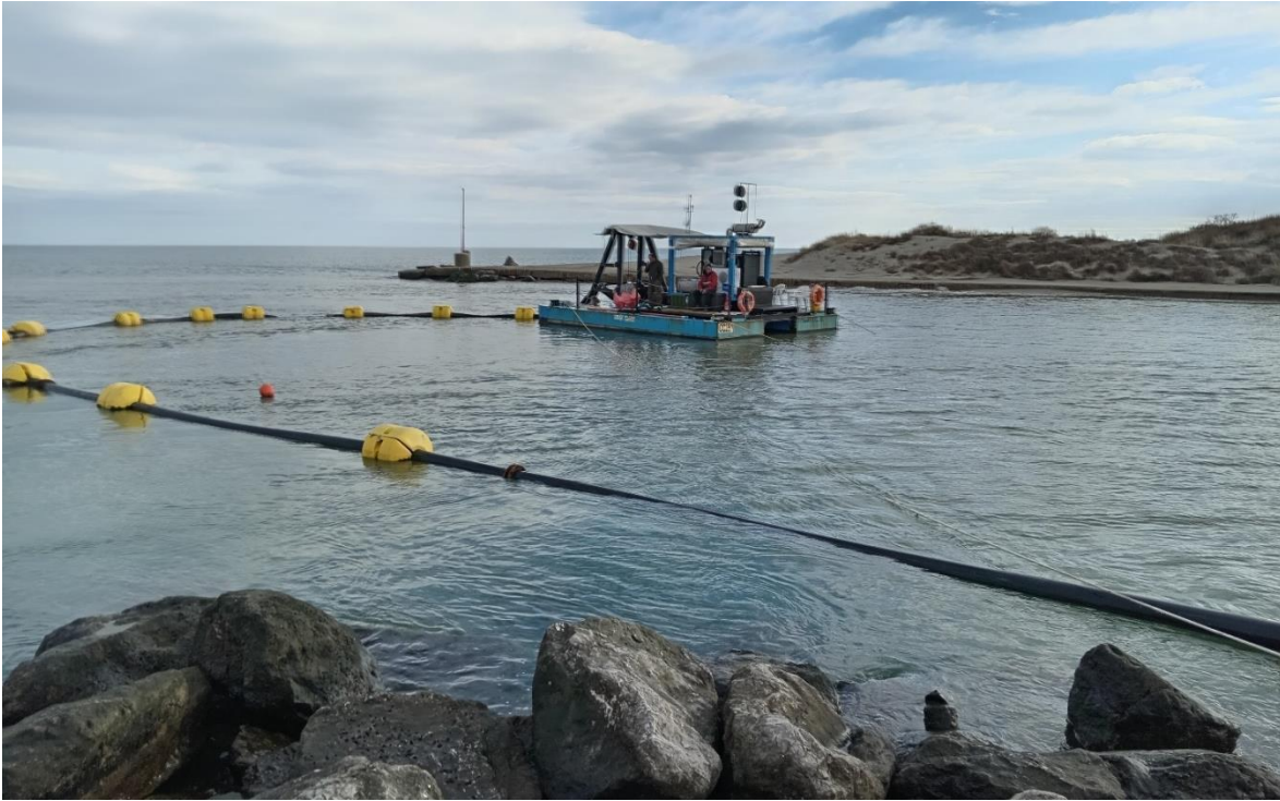
Figura 36: Esempio di battello con draga aspirante-refluente
