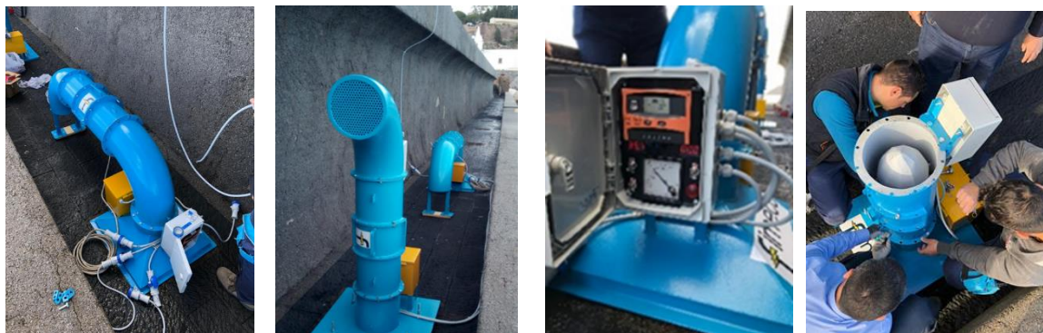
Figura 4-18. Turbina di tipo Wells prevista per il progetto di Fuscaldo (CS).
