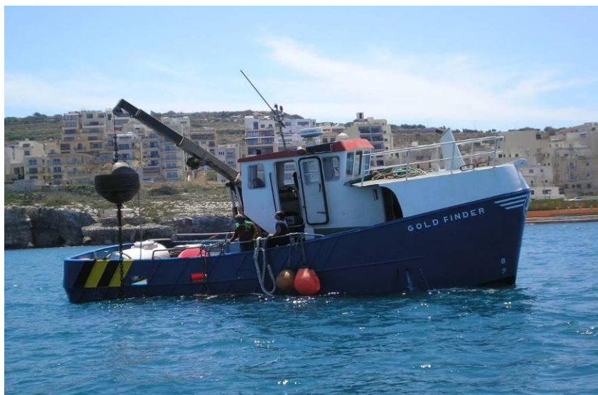
Figura 4-3. Campionamenti con Benna Van Veen
