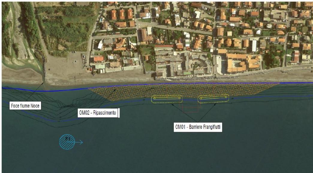
Figura 8-1 Ubicazione delle 2 barriere frangiflutto e del ripascimento artificiale
