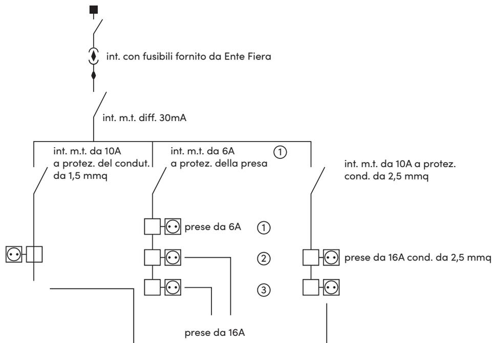
Le linee costituite da conduttori da mm<sup>2</sup> 1,5 saranno protette da int. m.t. da max 10A.
