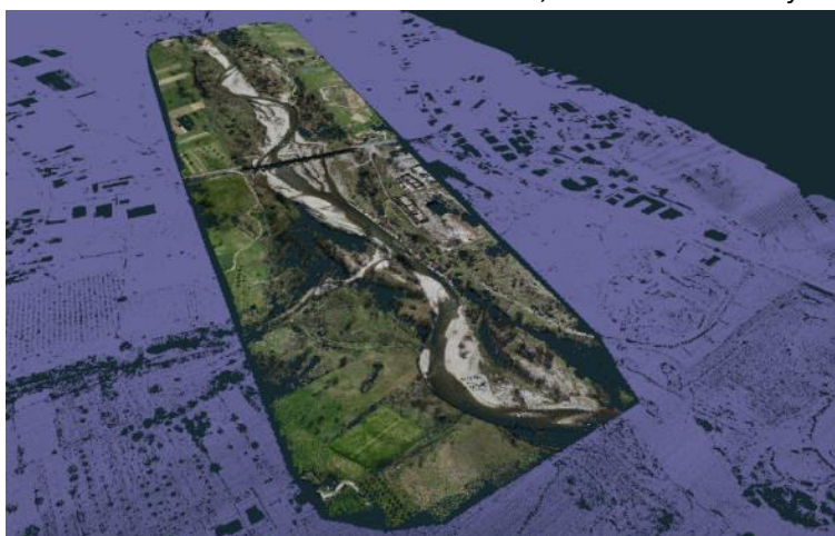
DETTAGLIO DELLA NUVOLA "IBRIDA" - In viola il dato del ministero, a colori il dato aerofotogrammetrico da drone
