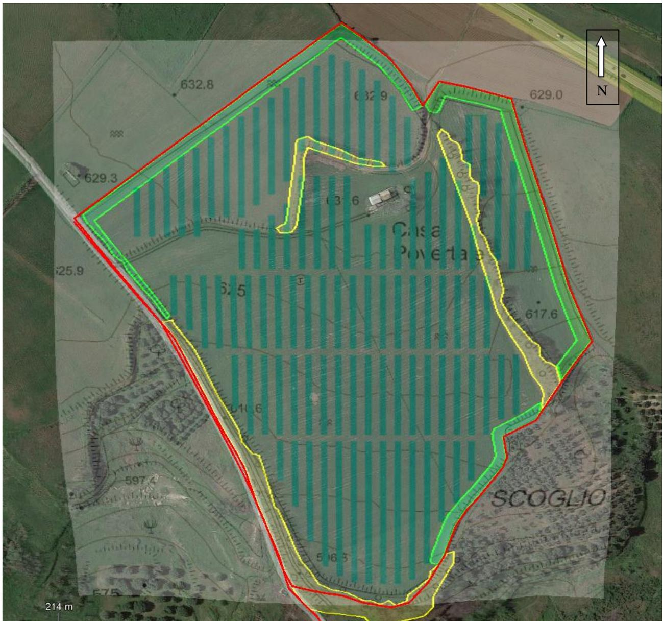
Fig. 2 Layout dell' impianto agrovoltaico “Zungri 1” (ortofoto su CTR).  = Moduli fv a inseguimento monoassiale.
