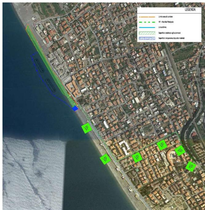
Figure 5- Planimetria generale di cantiere e viabilità
