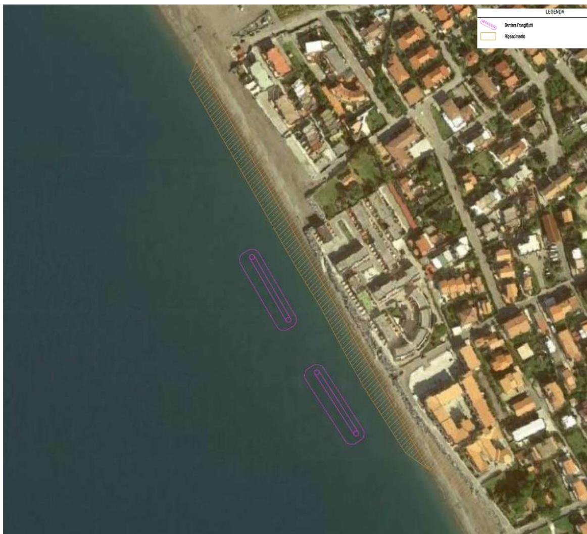
Figure 1- Ubicazione delle 2 barriere frangiflutto e del ripascimento artificiale
