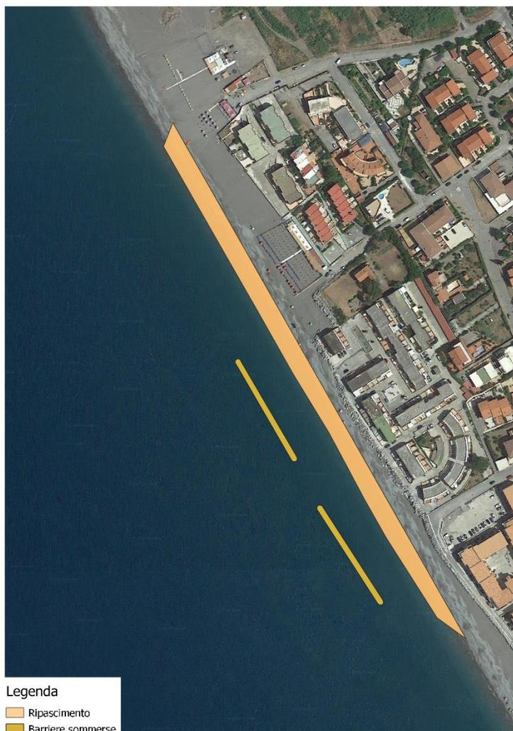
Figura 4-41 Ubicazione delle 2 barriere frangiflutto e del ripascimento artificiale
