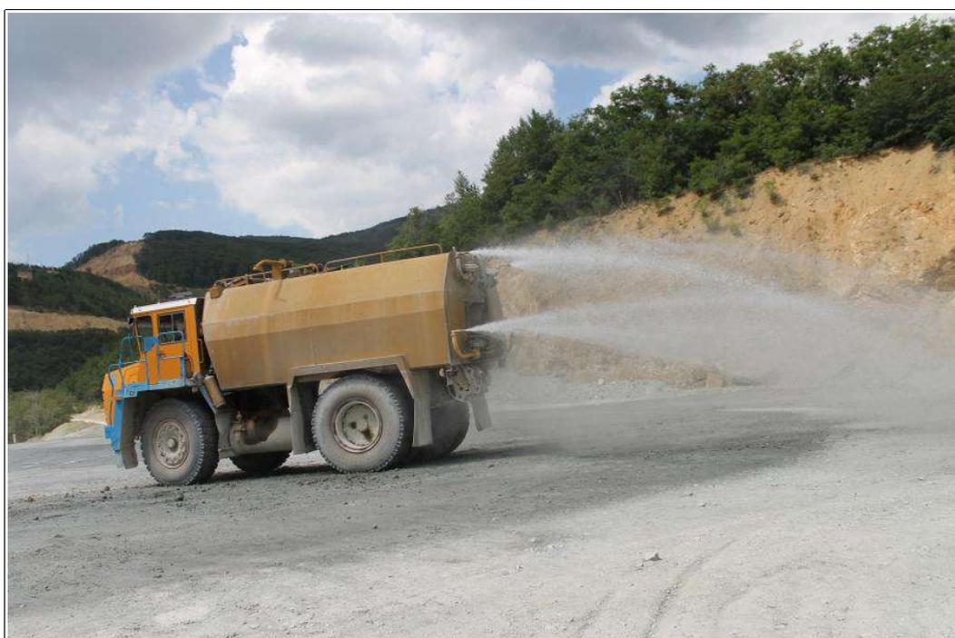
Figura 14: Bagnatura piste di cantiere per abbattere le emissioni polverose
