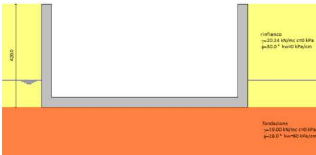
Figure 30 – Modello di calcolo CASO 2 (analisi statiche e sismiche di lungo termine)
