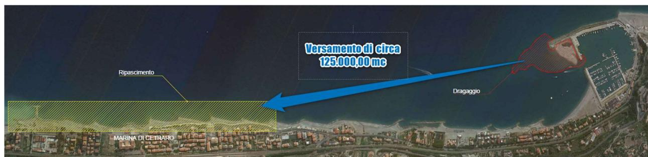
Figura 3-5 Individuazione del sito da ripascere con i materiali provenienti dalle operazioni di dragaggio dell'imboccatura
