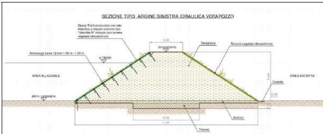
Figura 15 Sezione tipo argine Votapozzo
