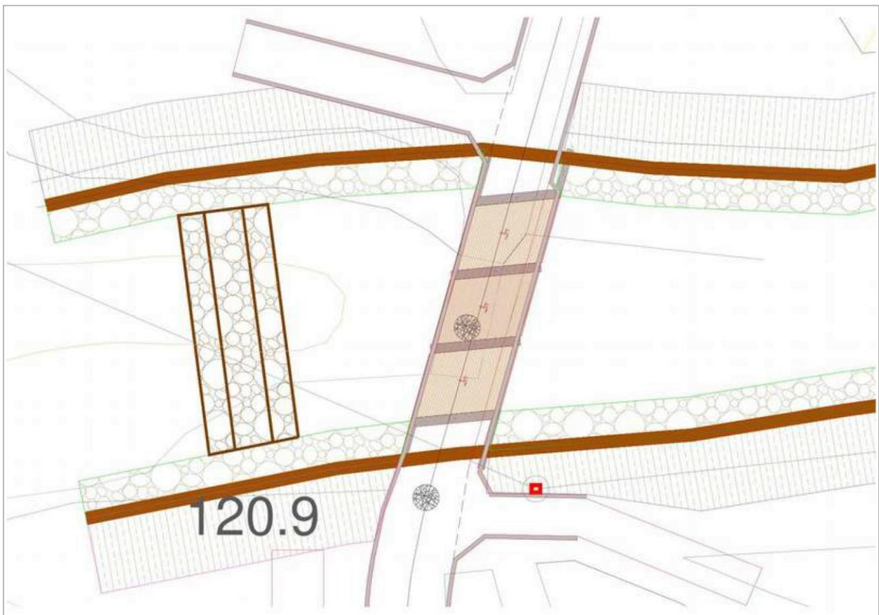
*Figura 8 Schema planimetrico attraversamento - Vista setti e soletta*
