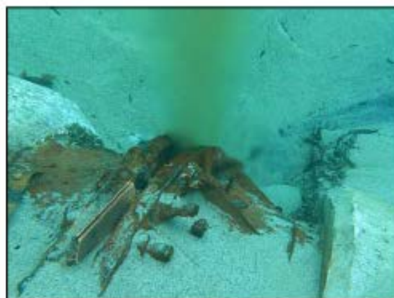
Flangia, e perdita, del tubo a 105mt
